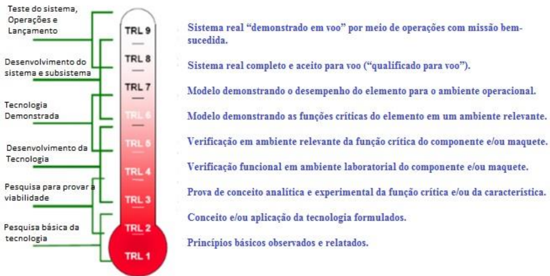
Figura 1- Termômetro de representação dos níveis de TRL (NASA, 2016).
